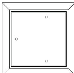
Las trampillas de registro son utilizadas en sistemas de montaje de placas de yeso laminado en falsos techos, trasdosados o cerramientos de huecos de paso de instalaciones.
