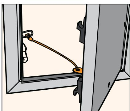
**Sistema de apertura parcial mediante retención por cable metálico.**
